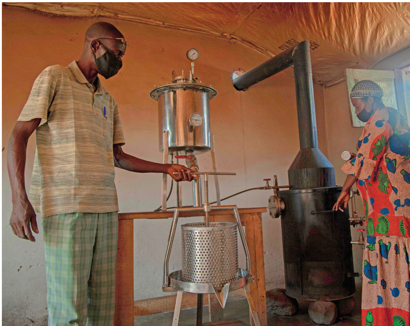
Des membres d'une organisation de producteurs utilisent une VitaGoat pour transformer le soja. [Photo CRS]
