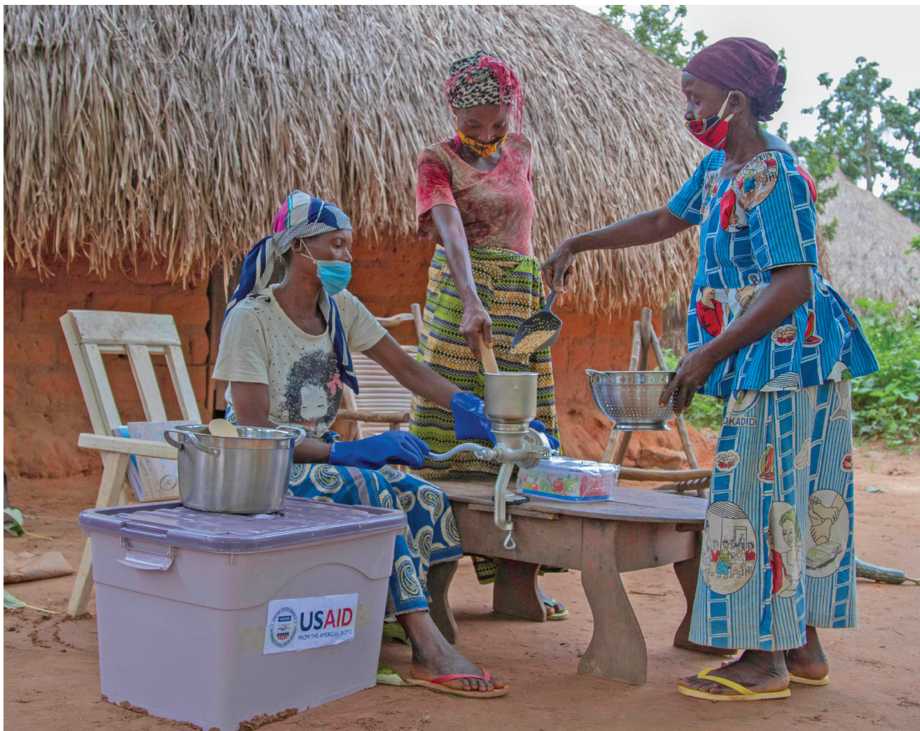
Des membres d'une organisation de producteurs utilisent un SoyaKit pour transformer le soja en boisson au soja. [Photo CRS]
