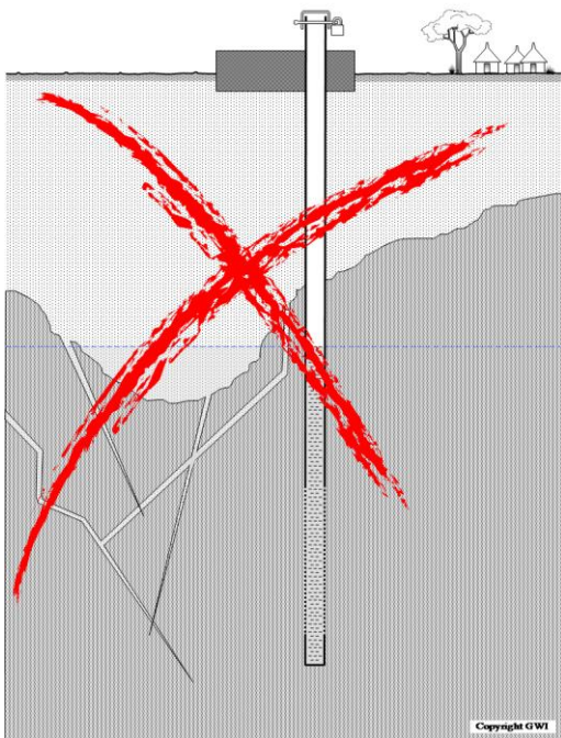
Figure 3: mauvaise implantation en zone de fracture
